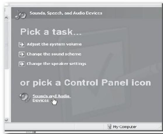
Als u de mixer als standaard ingang/uitgang wilt gebruiken (voor systeemgeluiden en opnamesoftware), kunt u dit instelling in "weergave" en "opname" van de geluidstab. Let wel op dat u geen geluidslus maakt door beide tegelijkertijd open te zetten!
