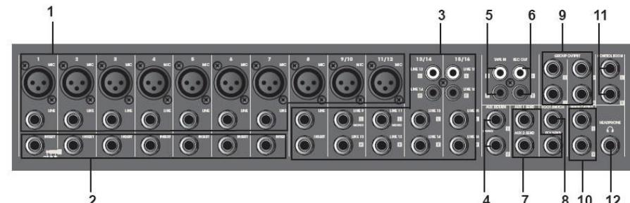
**1. KANALEINGÄNGE****SYMMETRISCHE MIKROFON XLR-Anschlüsse**
