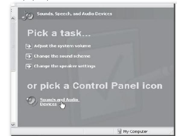
Pour utiliser le mixer en tant qu'appareil d'entrée et de sortie par défaut (pour des systèmes sonores et des softwares d'enregistrement audio), assurez-vous que dans le tableau réservé à l'audio, les fonctions de lecture et d'enregistrement soient activées et bien réglées.
