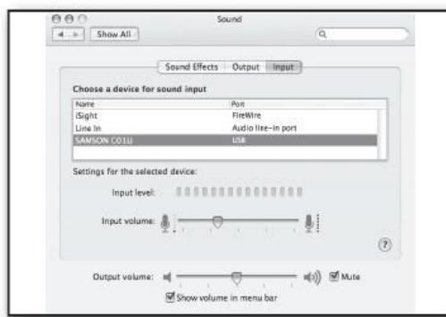
Jetzt klicken Sie auf die Output-Registerkarte und wählen USB Audio Codec. Sie werden vielleicht bemerken, dass der Lautstärkenschieber sich automatisch auf den vollen Pegel einstellt. Dies wird Ihnen ermöglichen, die HAUPT-Regler des Mixers zu benutzen, um den genauen Ausgangspegel einzustellen.
